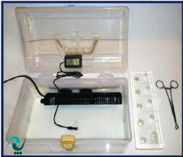
تجهیزات مربوط به گرمخانه (بن ماری): مخزن آب، دماسنج، پنس و پلیت نگهدارنده آمپول واکسن
